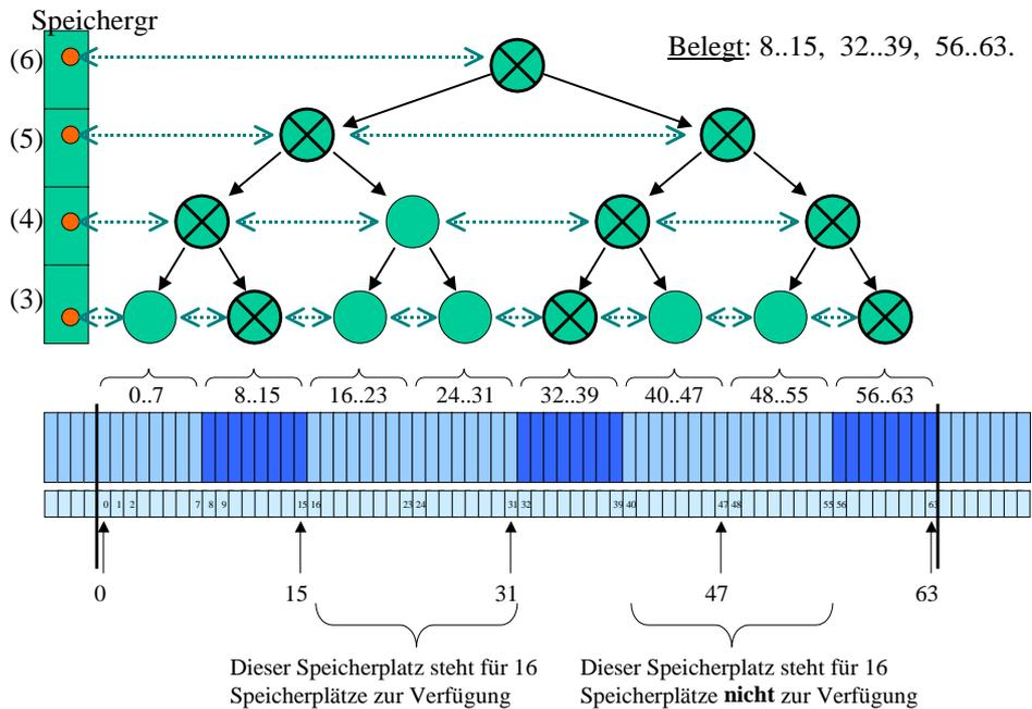
Wir nummerieren die Halbe also von 0 bis  $2^{\text{maxk}} - 1$  durch. Die kleinste Blockgröße sei  $2^{\text{mink}}$ . Alle Speicherblöcke mit festem  $\text{mink} \leq k \leq \text{maxk}$  stehen in einer Liste, erreichbar über den Zeiger des Feldelements  $\text{Speichergr}(k)$ .
